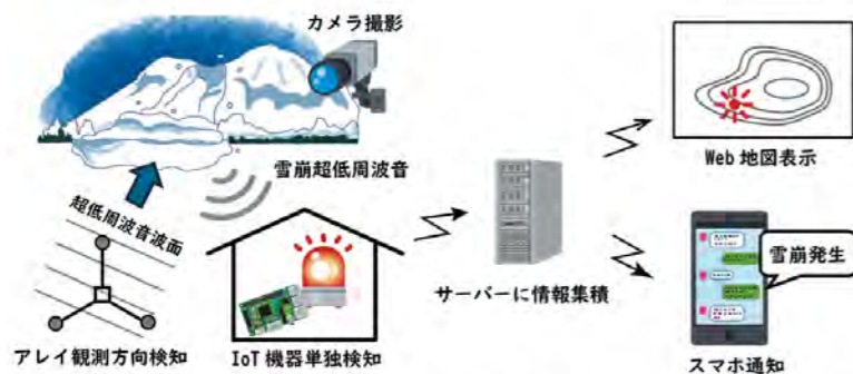
超低周波音を使った雪崩検知・通報システム概念図
