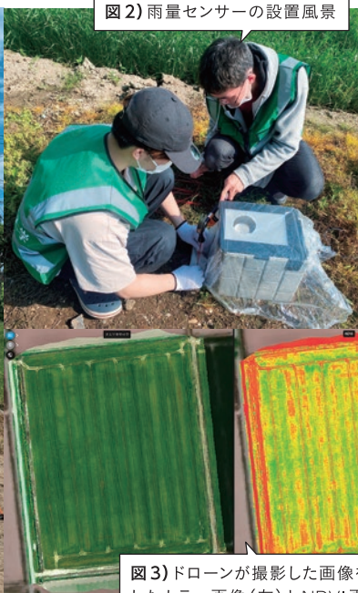
図2) 雨量センサーの設置風景
